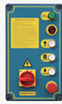
24V düşük voltajlı kontrol paneli
